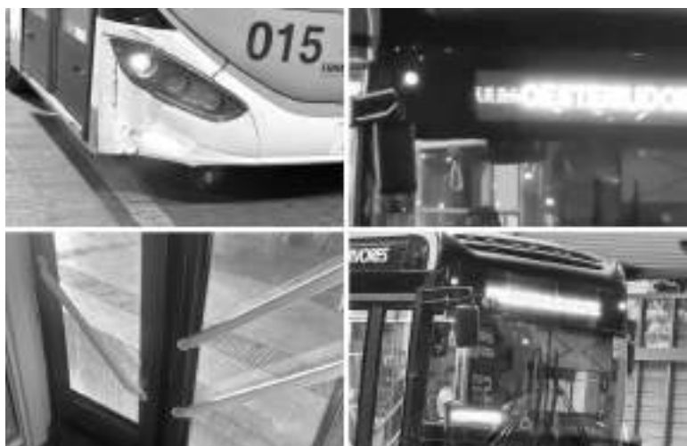
Diversos problemas identificados nos ônibus elétricos de Cascavel: dianteira amassada após colisão, painel eletrônico com falhas, pega-mão quebrado e iluminação de LED danificada
